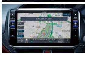
※後方車両検知は、車両後方より一定距離/一定時間の接近を検知した場合、「後方注意」と判断して画面表示と録画を行います。
